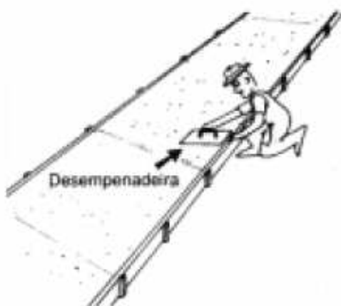
Figura 3 – Acabamento da calçada
